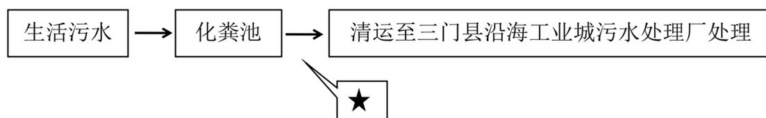
图 3-1 废水处理工艺及监测点位图
