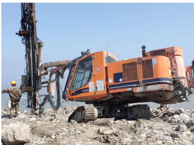
干式凿岩作业（潜孔钻机自带布袋除
