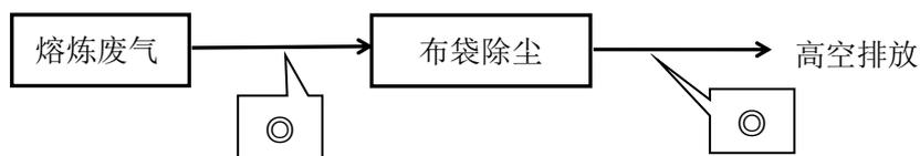
图 4-1 熔炼废气处理工艺及监测点位图
