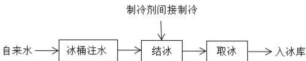
图 2-1 透明冰生产工艺流程图
