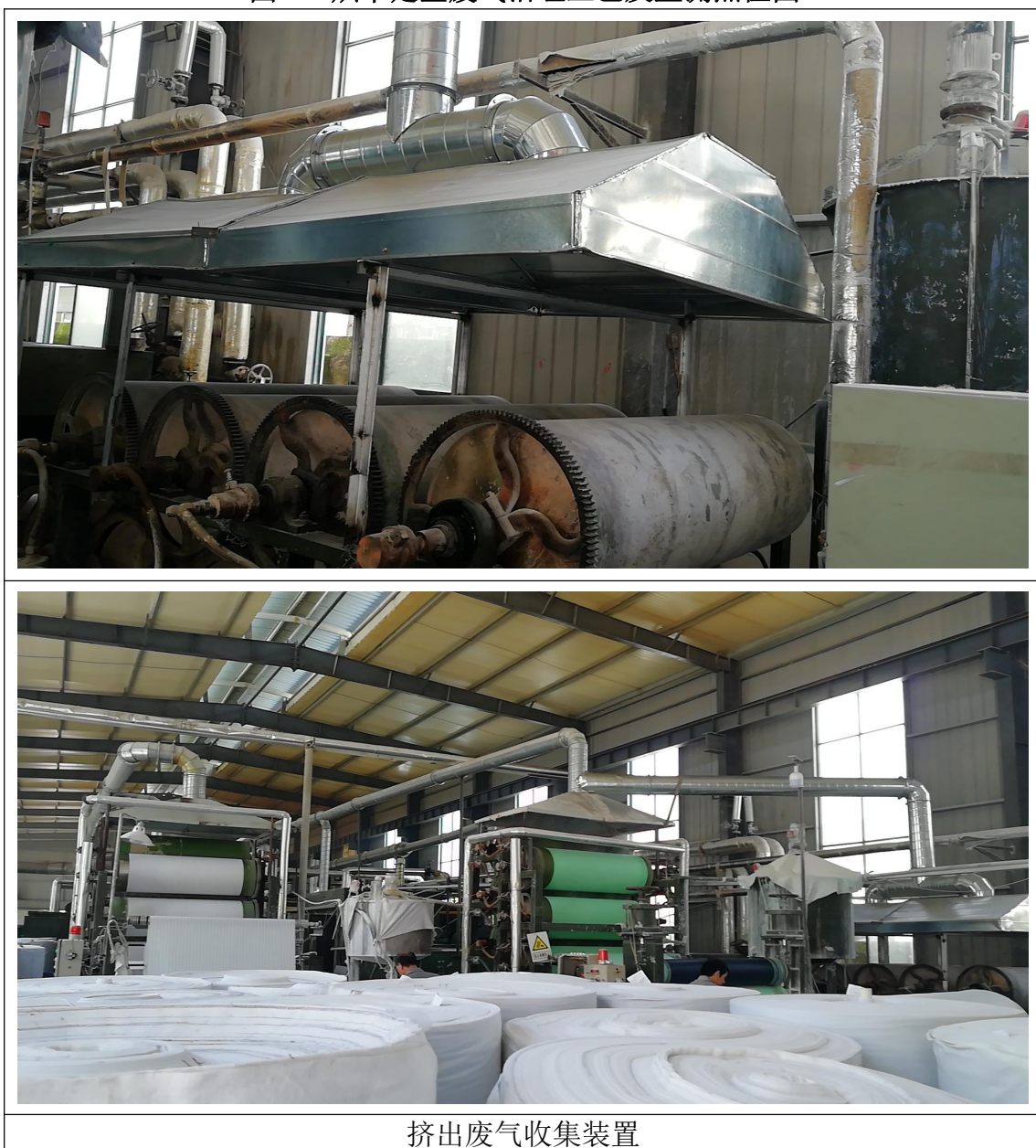
图 4-4 烘干定型废气治理工艺及监测点位图
