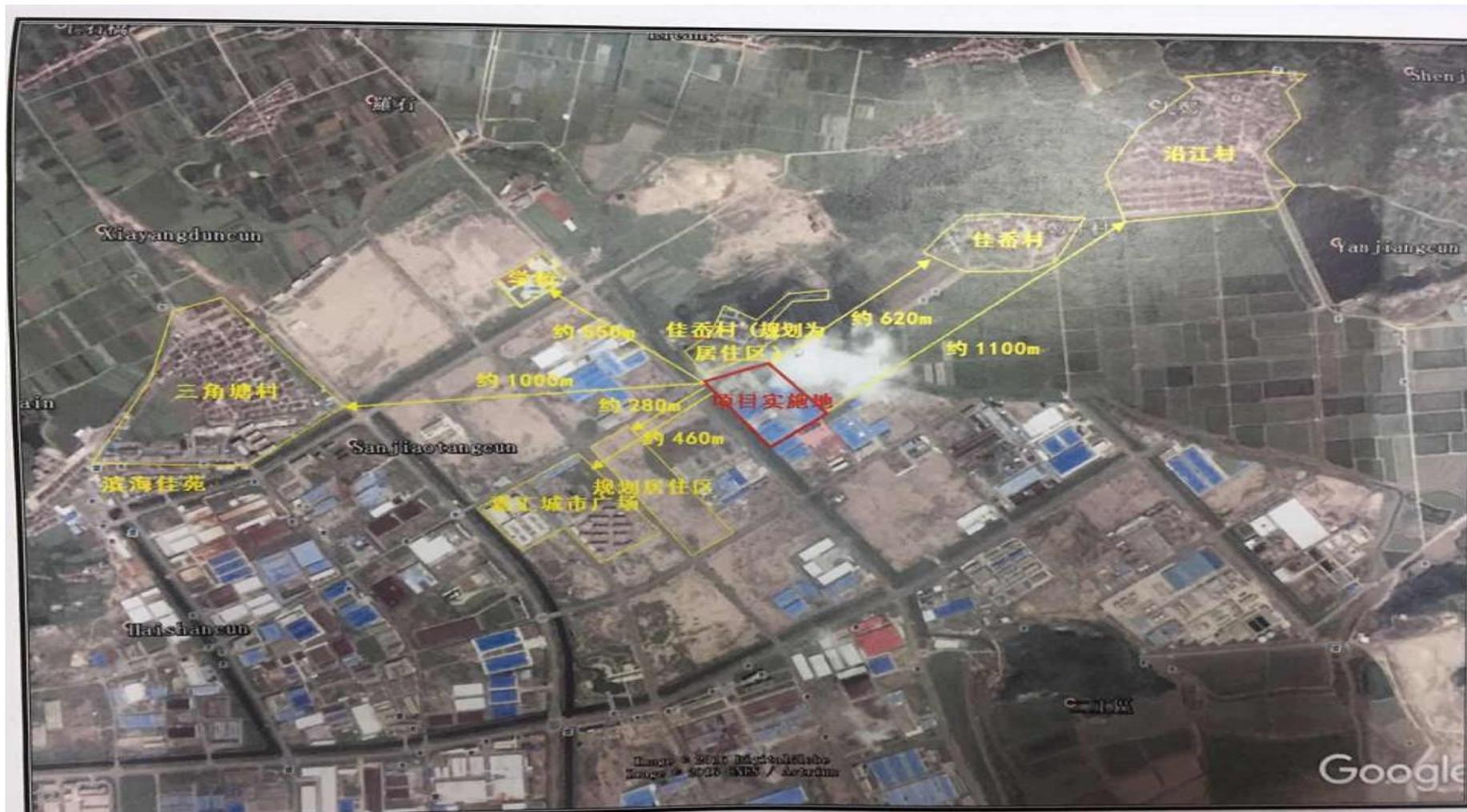
附图3 厂区平面布置图及卫生防护距离包络线图
