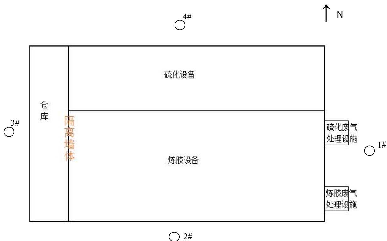
图 7-3 无组织废气监测点位示意图
