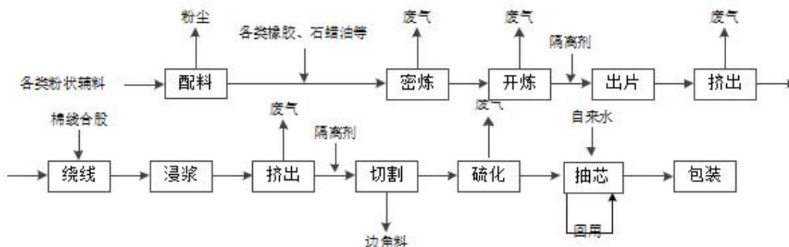
图 3-2 项目橡胶管（棉编）产品生产工艺流程图
