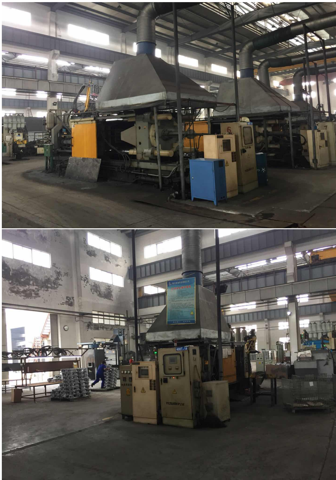
附图14 压铸车间及排风装置
