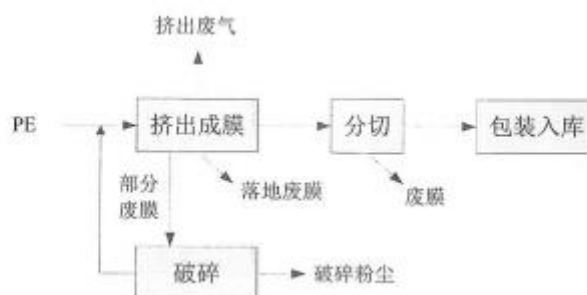
图 2-3 PE 塑料收缩膜生产工艺流程图
