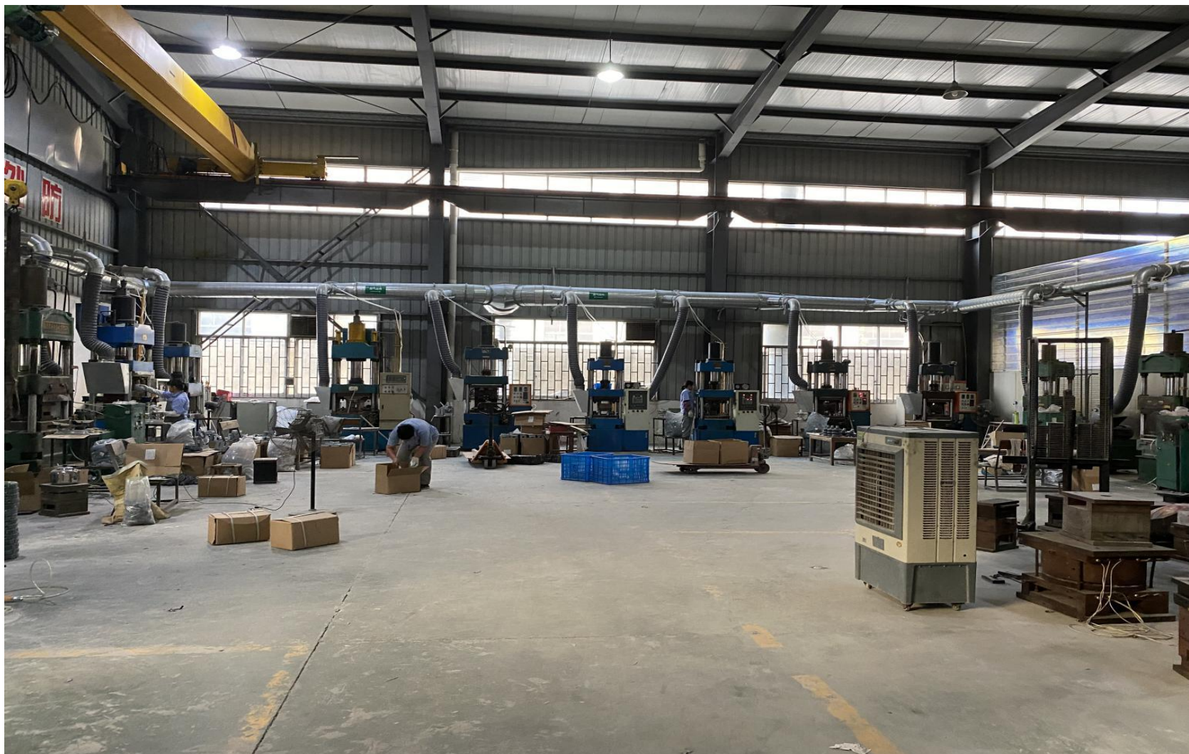
附图8 压制废气处理设施
