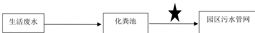
图 7-1 废水处理流程及监测点位示意图
