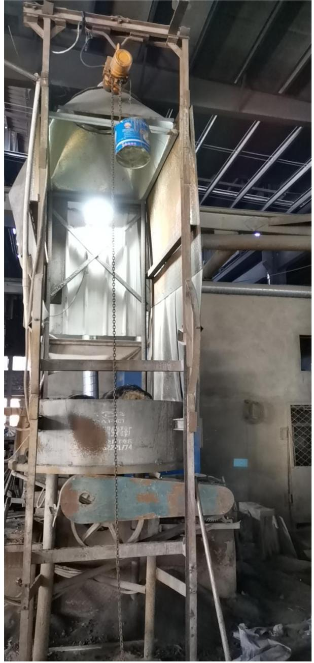
混沙废气收集
