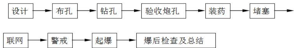
图 2-3 本项目爆破施工工艺流程图
