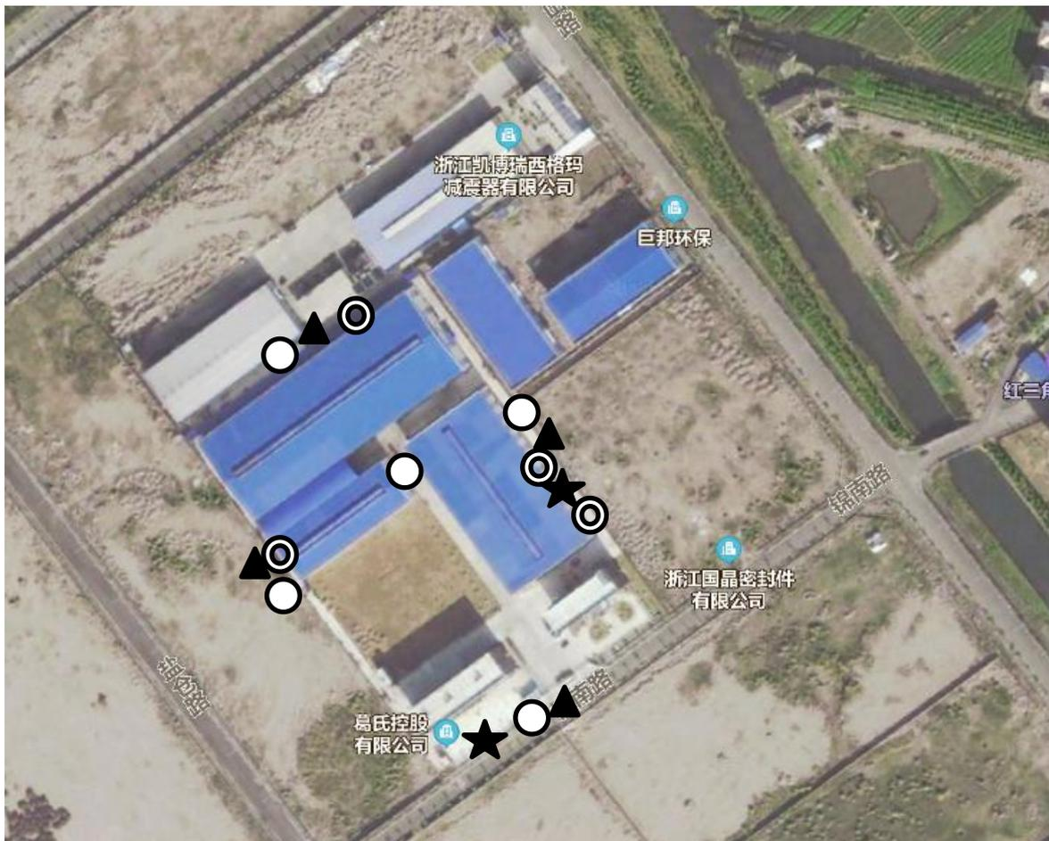
注：▲ 表示噪声采样点位，○ 表示无组织废气采样点位，◎ 表示有组织废气采样点位，★ 表示废水采样点位。
