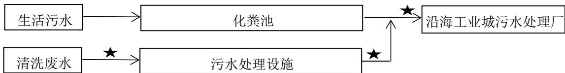
图 6-1 废水采样点位示意图
