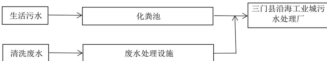
图 3-1 实际废水处理流程图
