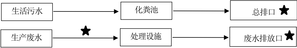
图 7-1 废水处理流程及监测点位示意图
