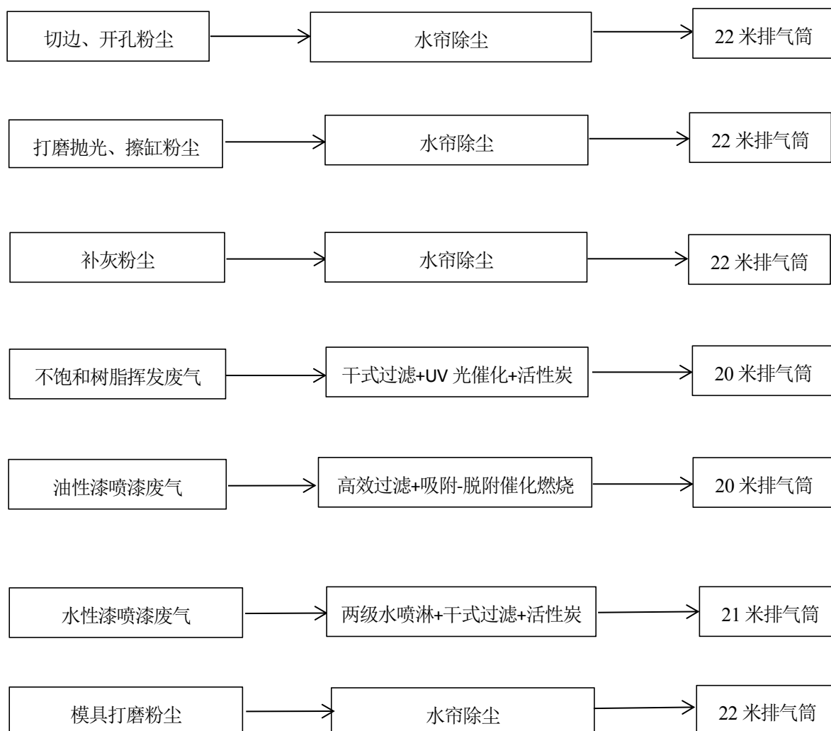
图4-1 废气处理工艺流程图
