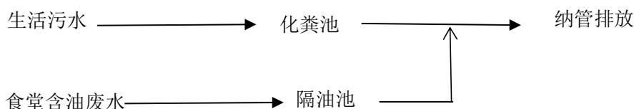
图 4.1-1 实际废水处理流程图
