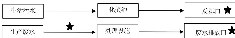
图 7-1 废水处理流程及监测点位示意图
