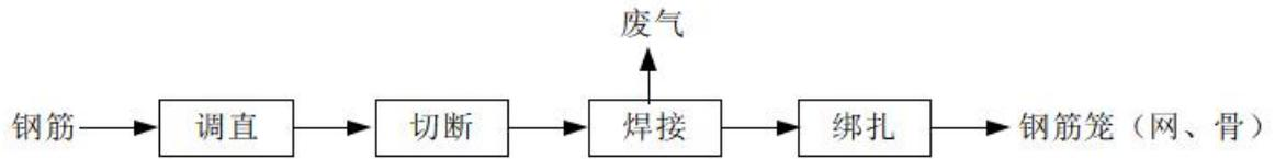
图2-3 钢筋笼（网、骨架）加工工艺流程图
