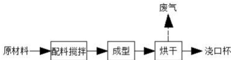
图3-5 浇口杯生产工艺流程图
