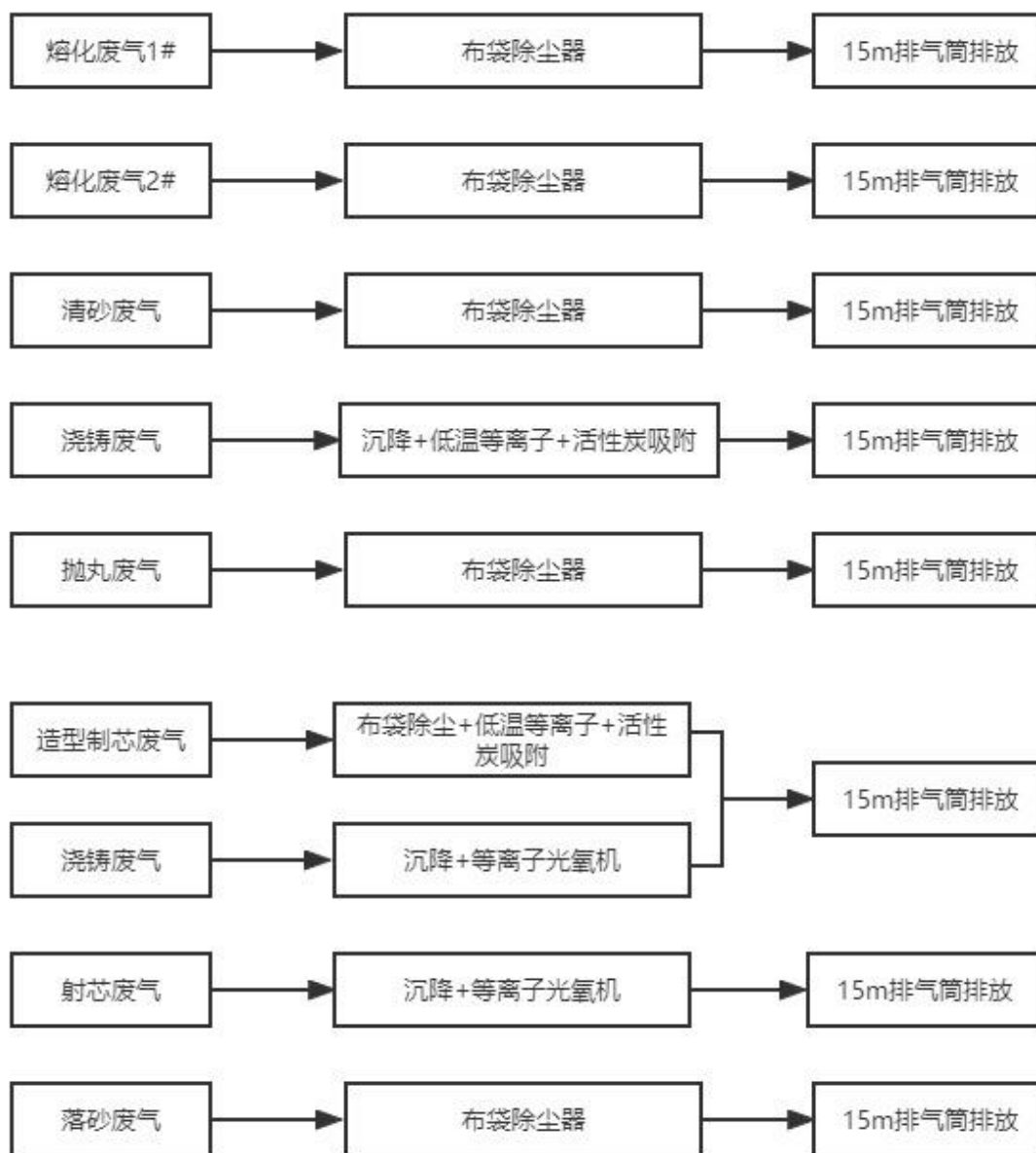
图4-2 废气处理流程图
