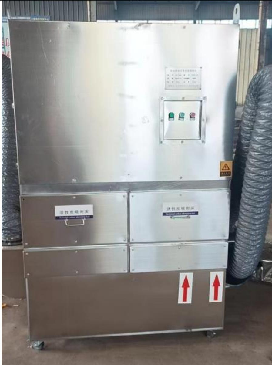
移动式漆雾有机废气净化装置
