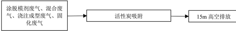
图 3-2 实际废气处理流程图
