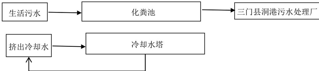
图 3-1 废水处理流程图
